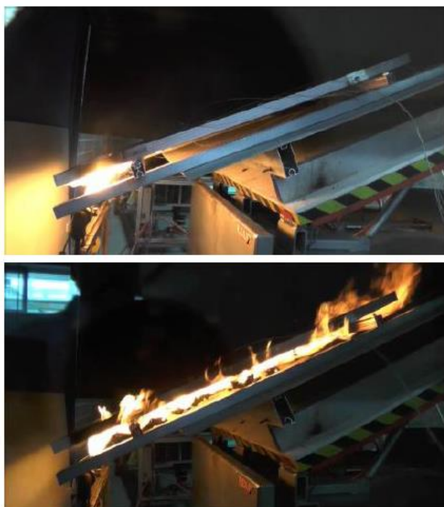
Figur 3 Uppställning av experiment för undersökning av brandbeteende. (18)
