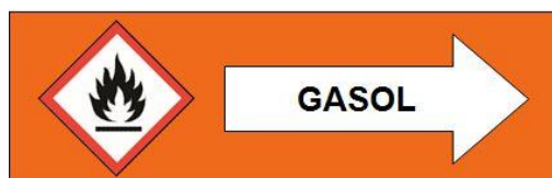
Exempel på märkning av rörledning med gasol
